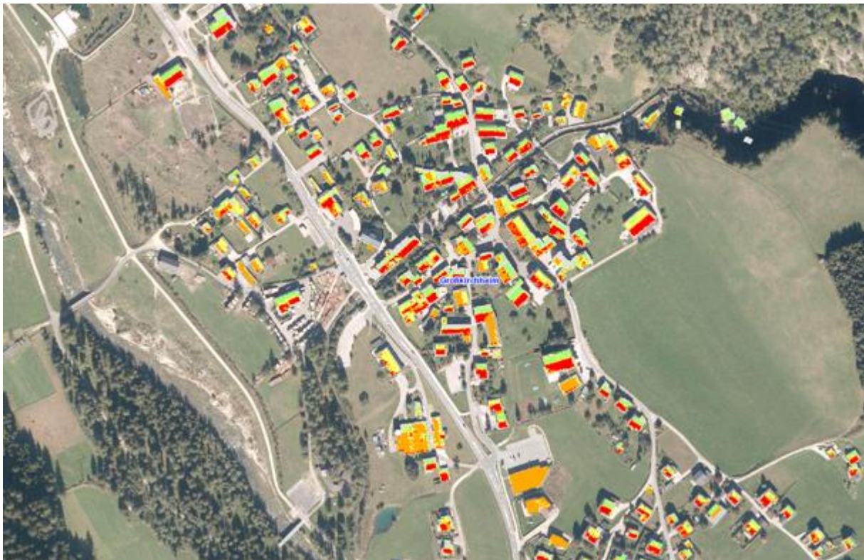
Abb. 42: Solarpotentiale auf Dachflächen im Gemeindehauptort Döllach, © Solarpotentialkataster Kärnten
