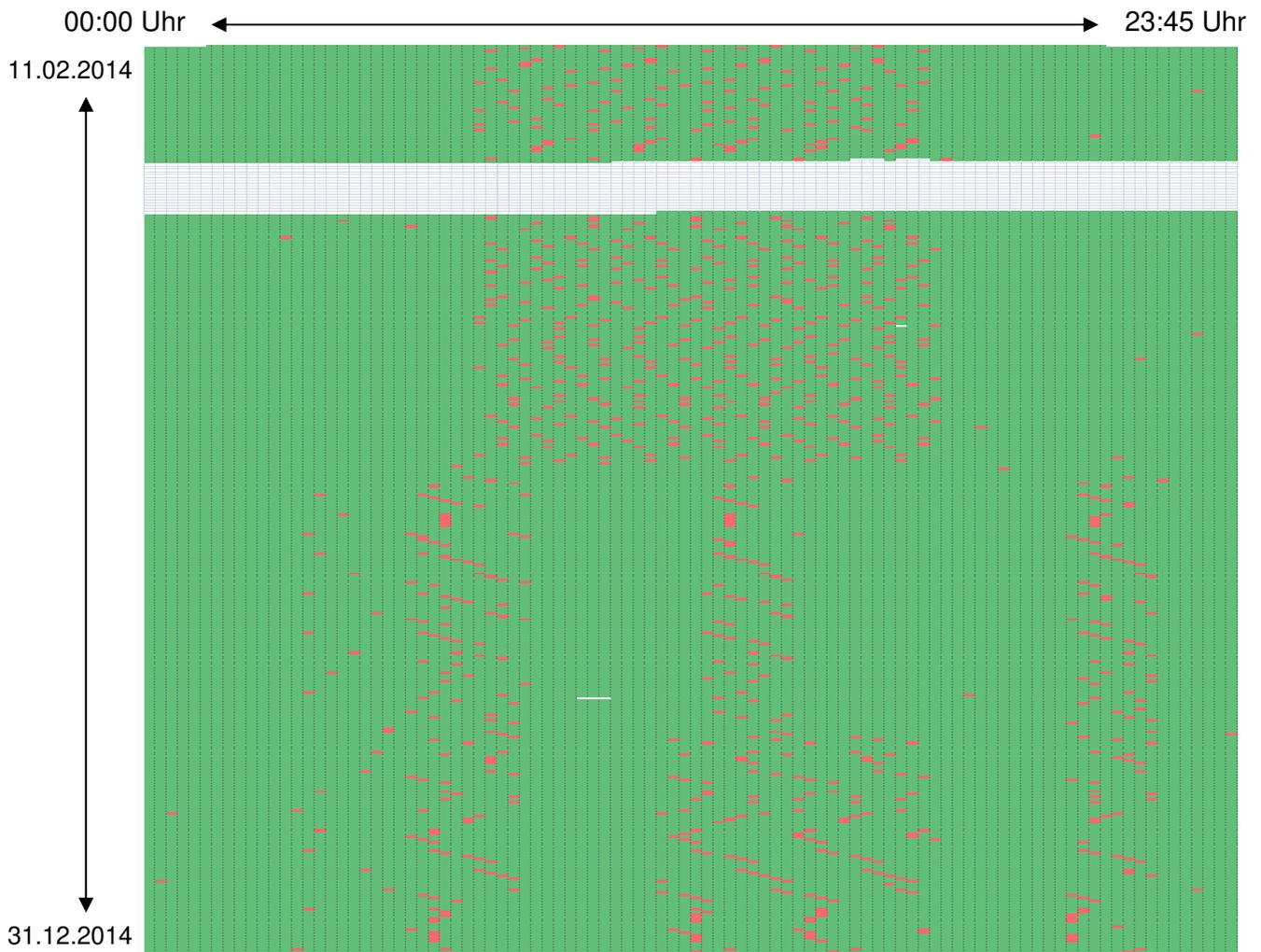
Abbildung 126: Carpet Plot Stromverbrauch Lüftung [kWh], 2014
