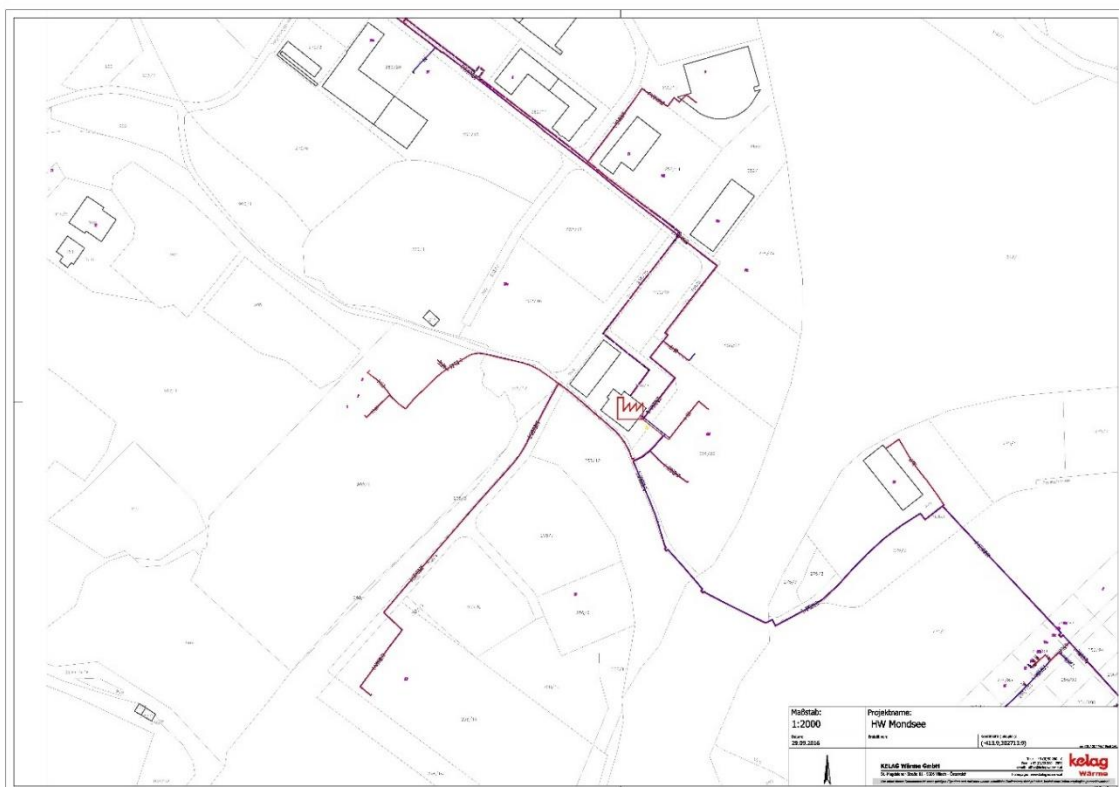
Abb. 11: Leitungsnetz HW Mondsee (Quelle: KELAG WÄRME GMBH 2016).
