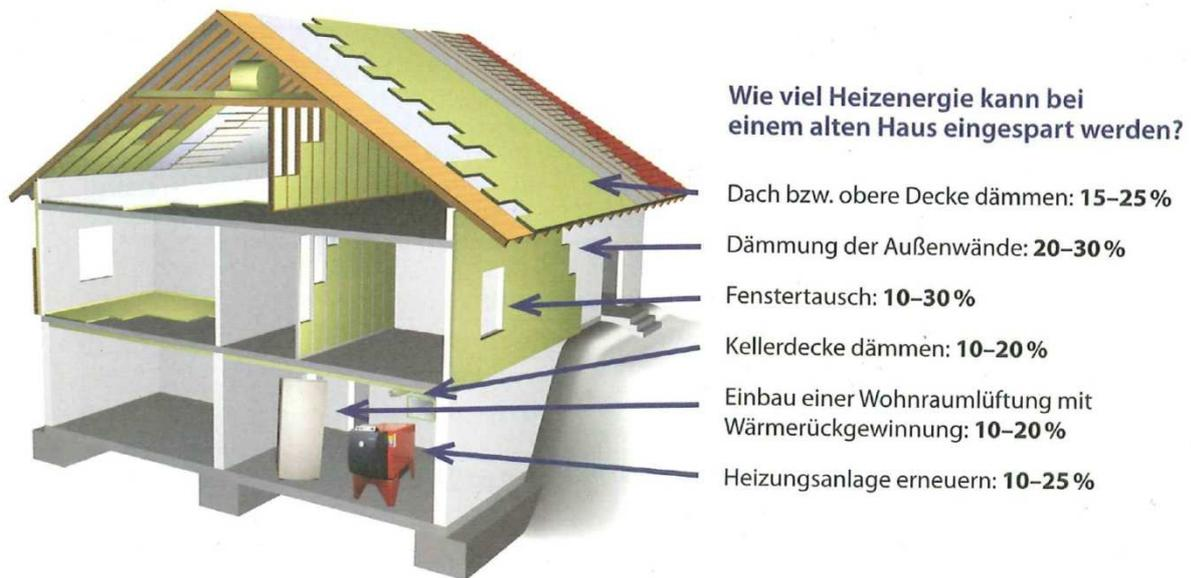
Abbildung 15 Einsparpotential Heizenergie bei verschiedenen Maßnahmen
